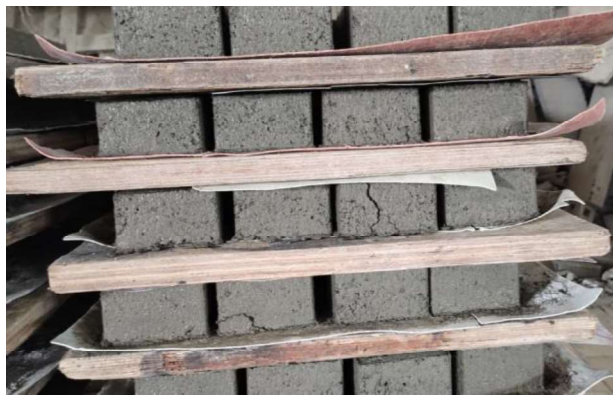
Gambar 1.1 Contoh produk defect paving block CV. Sumber Makmur
