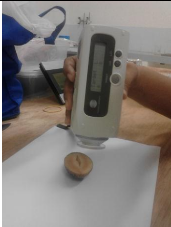
Mengukur tingkat kewarnaan buah sawo menggunakan alat colour reader
