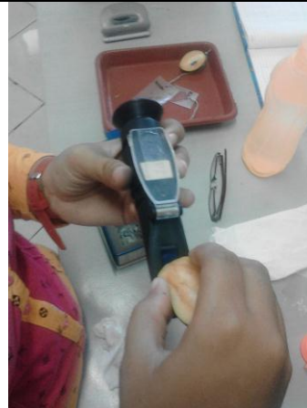
Mengukur kadar gula buah sawo menggunakan alat handrefractometer
