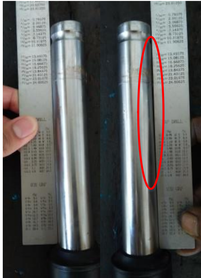
Gambar 1.3 Hasil pres sisi tabung garpu
