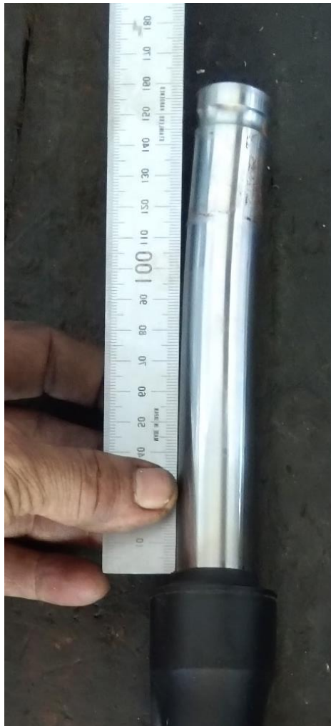
Gambar 1.2 Tabung garpu bengkok jarak pendek
