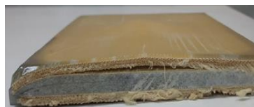
Gambar 1. 2 Material komposit alami rompi anti peluru (Abdelal, 2024)
