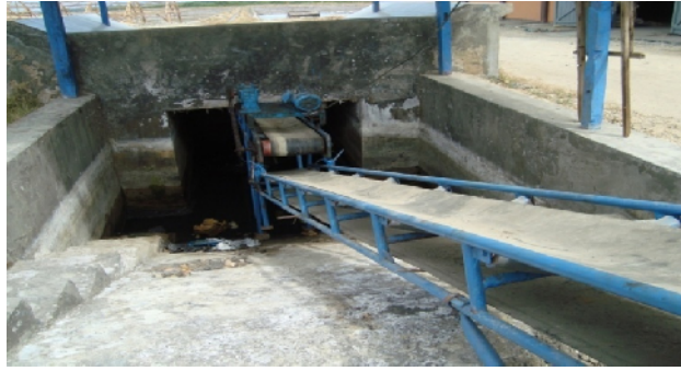
Gambar 8. Konveor pengangkut garam ke dalam gudang
