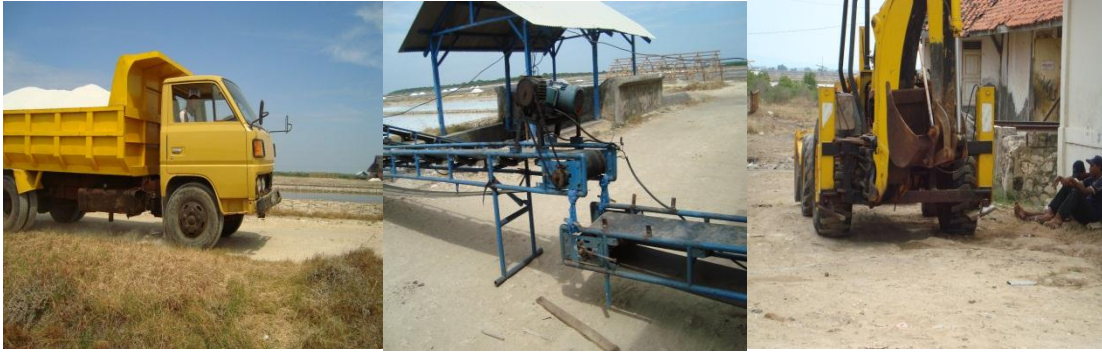
Gambar 4.12 : Alat Untuk Mengangkut Garam dari Tempat Penjemuran ke Gudang, (a) Truk, (b) Conveyor, (c) Eskavator
