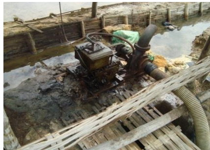
Gambar 4.9 : Pompa air dari peminihan ke meja kristalisasi
