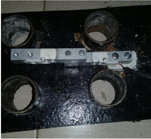
Gambar 4.5 Pengujian sensor load cell pada prototipe pembuat briket otomatis.
