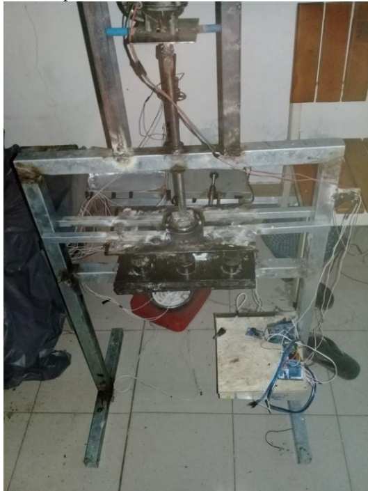
Gambar 4.1 Hasil prototipe pembuat briket otomatis tampak depan.
