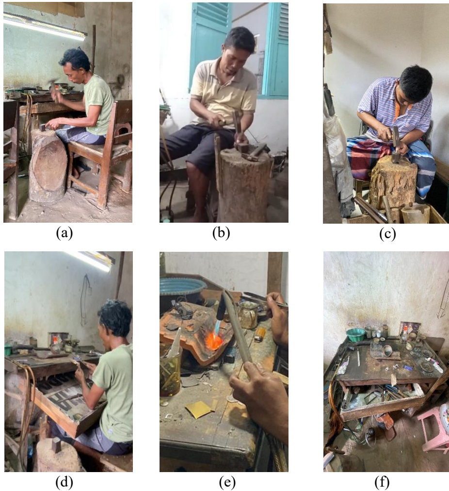
Gambar 1.1 Proses pembuatan tubuh cincin; (a) Pengrajin 1, (b) Pengrajin 2, (c) Pengrajin 3, (d) Pengikiran, (e) Peleburan, (f) Fasilitas stasiun kerja
