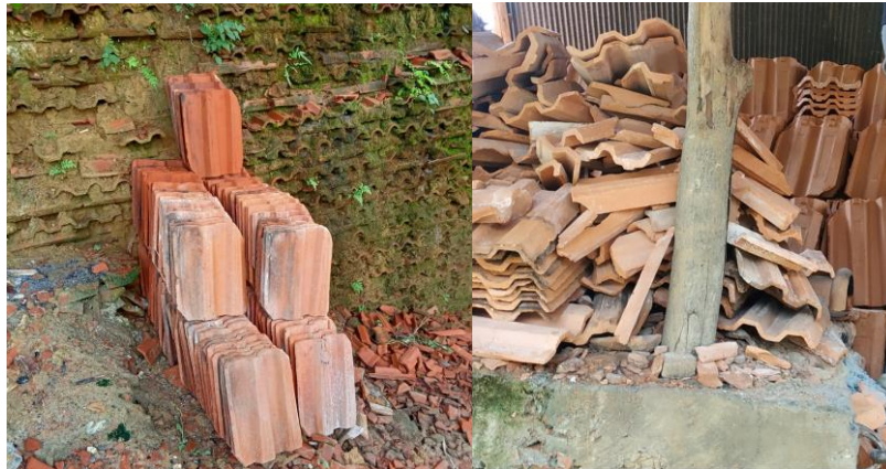
Gambar 1.1 Genteng retak pada pabrik genteng karang penang
