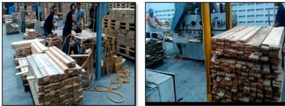
Gambar 1.1 Permasalahan penumpukan material akibat work in process (Sumber: Eka Rahmawati Puspitasari, 2018)
