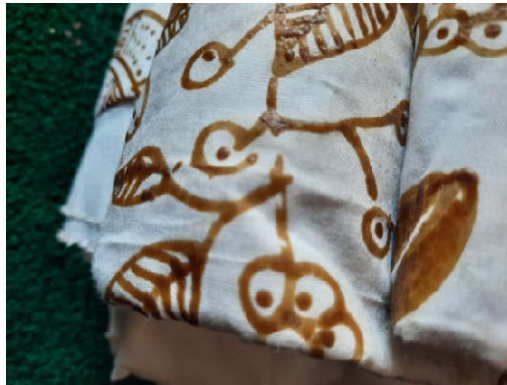
Gambar 1.6 Gambaran jenis cacat garis tepi tidak menyambung dengan yang lain
