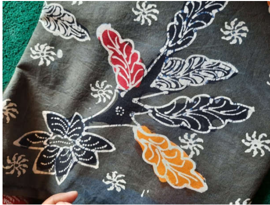
Gambar 1.3 Gambaran jenis cacat cat jembret atau cat di luar pola
