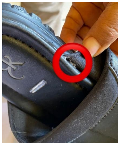
Gambar 1.2 Cacat sandal yang lem kurang menempel
