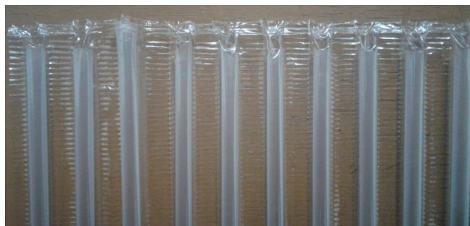
Gambar 1.2 Produk cacat (sedotan dalam kemasan tergencet)
