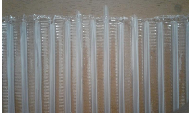
Gambar 1.3 Produk cacat ( seal plastik sedotan tidak tertutup sempurna)
