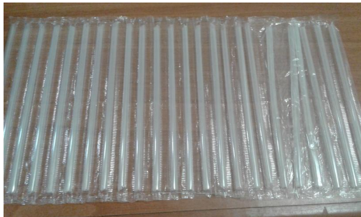
Gambar 1.7 Produk cacat (sedotan dalam kemasan bengkok)
