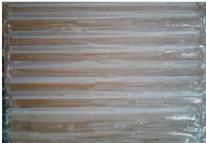
Gambar 1.4 Produk cacat (hasil perforasi sedotan renteng tidak pada tempatnya)
