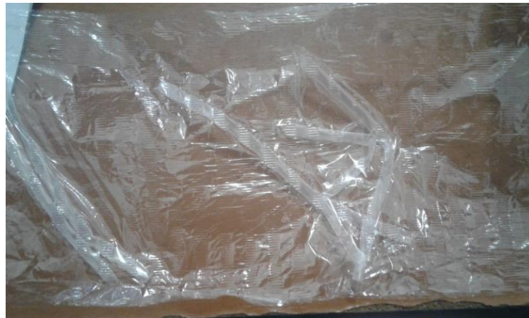
Gambar 1.5 Produk cacat (terjadi double pack dalam kemasan sedotan)
