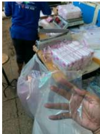
Gambar 1.3 Produk cacat seal terbuka plastik PE PT. HSKU
