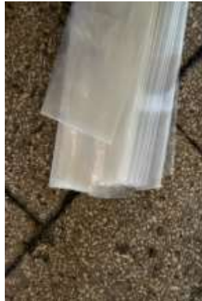
Gambar 1.2 Produk cacat tidak simetris plastik PE PT. HSKU
