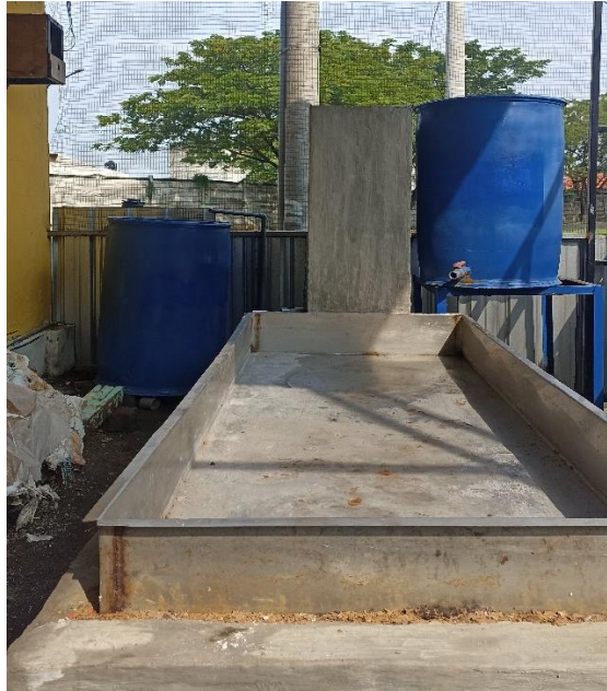
Gambar 1.1 alat rekristalisasi garam laboratorium industri garam Fakultas Teknik
