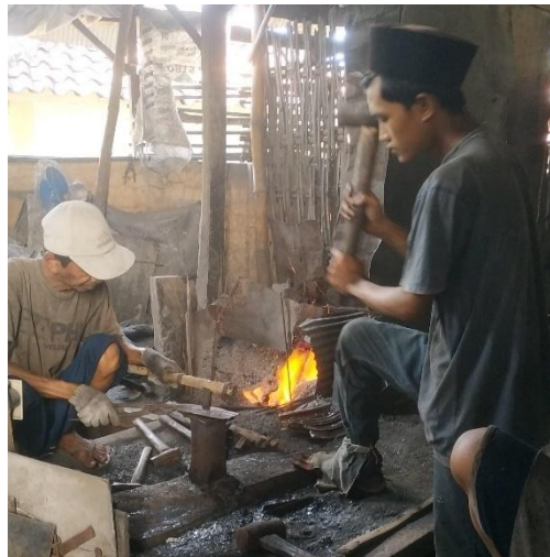
Gambar 1.1 proses penempahan manual
