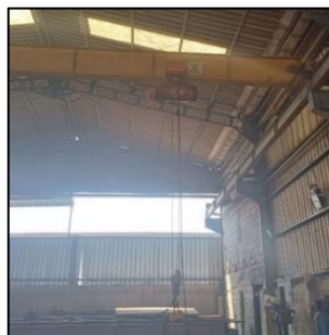
Gambar 1.1 Proses pengangkutan material/produk dengan mesin hoist crane
