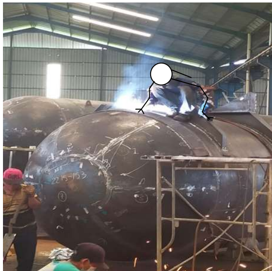
Gambar 1.1 Pengelasan shell dengan pet (Dokumentasi area produksi 3 dan 4)
