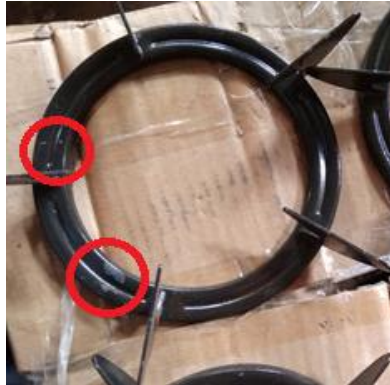
Gambar 1.2 kecacatan enamel mengelupas pada part tungku DNS 9900 e
